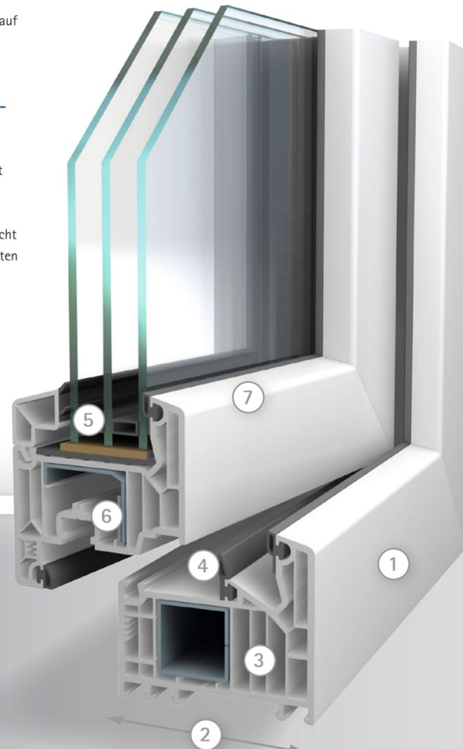
Mit SOFTLINE 82<sup>MD</sup> setzen Sie zu Recht auf die beste Qualität: Die in Deutschland in der höchstmöglichen Profilqualität (Klasse A nach DIN EN 12608) hergestellten VEKA Systeme übertreffen vergleichbare Produkte z. B. beim Materialeinsatz um bis zu 14 %. Neben langfristiger Funktionssicherheit und jahrzehntelangem Wohnkomfort sorgen die starken Profilwände auch für:
